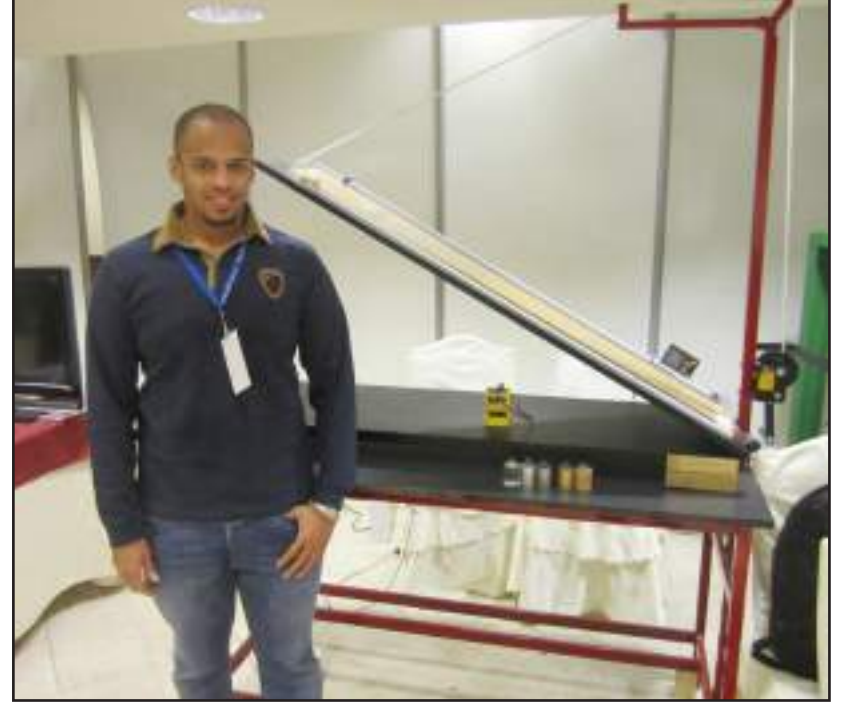
● الطالب مصعب الحصين مع جهاز قياس معامل الاحتكاك
